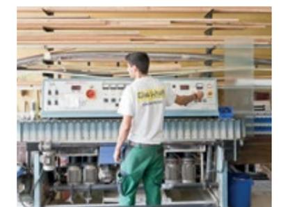
8-Spindel-Schleifautomat für schnelle Kantenbearbeitung
