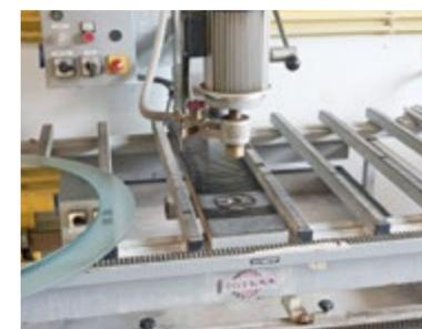
Für alle Fälle: Glasbohrmaschine
