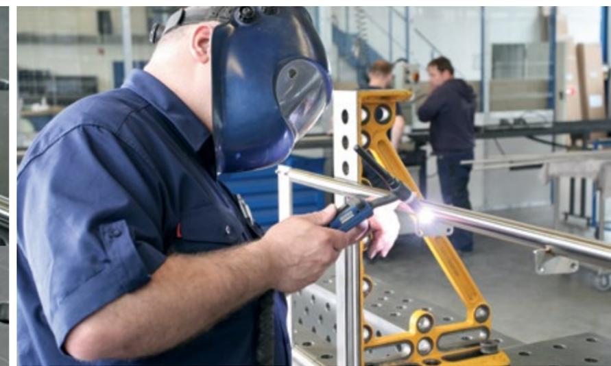
Positionierung der Stufenlaschen durch punktuell Anschweißen
